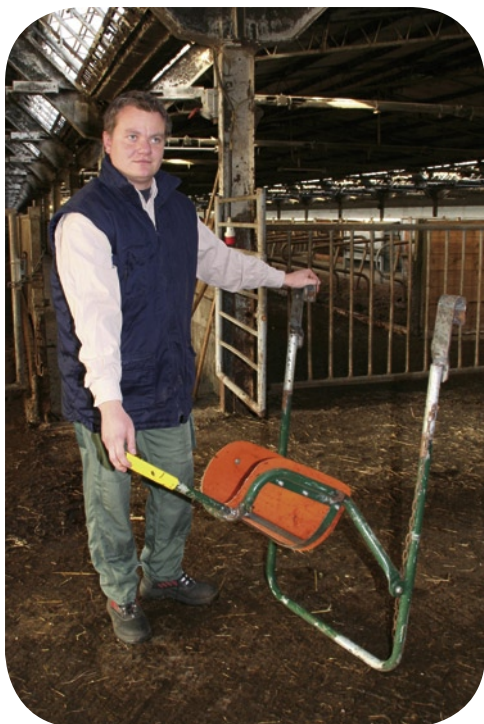
Die Kopfhalterung zum Einhängen am Fangstand ist eine Eigenentwicklung.
