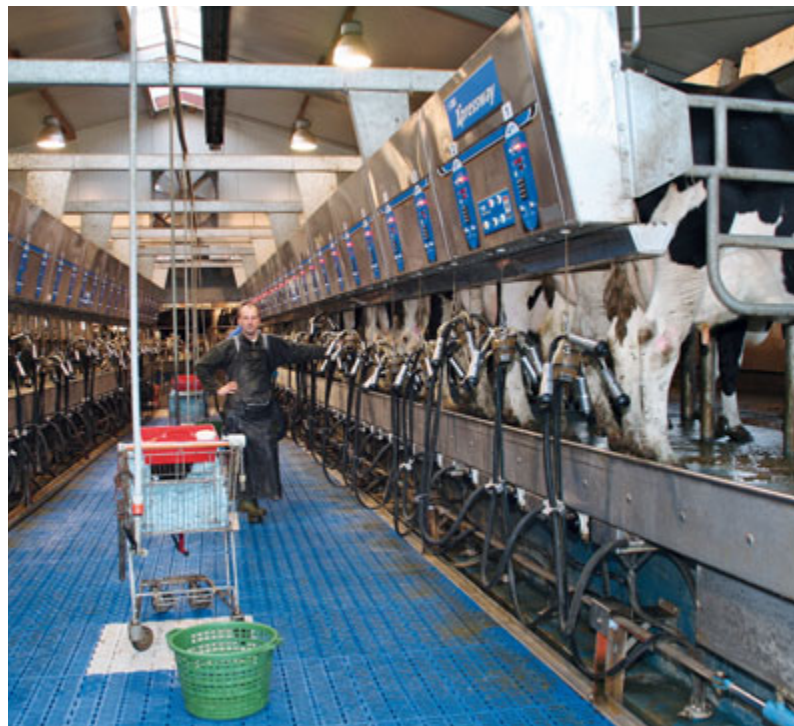
Der 24er-Side-by-Side-Melkstand mit Schnellaustrieb schafft einen Durchsatz von 150 Kühen pro Stunde. Melker und Kuh-treiber kommen auf dem Weg zum Melkstand an den Abkal-beboxen vorbei und sind in die Beobachtung der kalbenden Tiere mit eingebunden.
