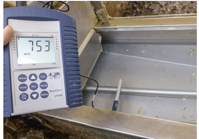
Eine Redox-Messung in einem dauerhaft hygienisiertem Tränkwasser-Becken auf dem Betrieb Kranzlhuber.
