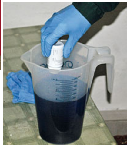
Der blaue Wasserstabilisator neutralisiert Chlorreste im Wasser, die den Impfstoff schädigen würden.
