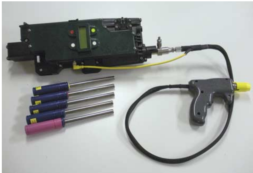
Mit einem solchen Gerät können Schweine ohne Injektionsnadel mit Medikamenten behandelt oder geimpft werden.
