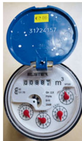
Um die genaue Wasseraufnahme im Kuhstall zu messen, eignen sich mechanische Wasseruhren.
